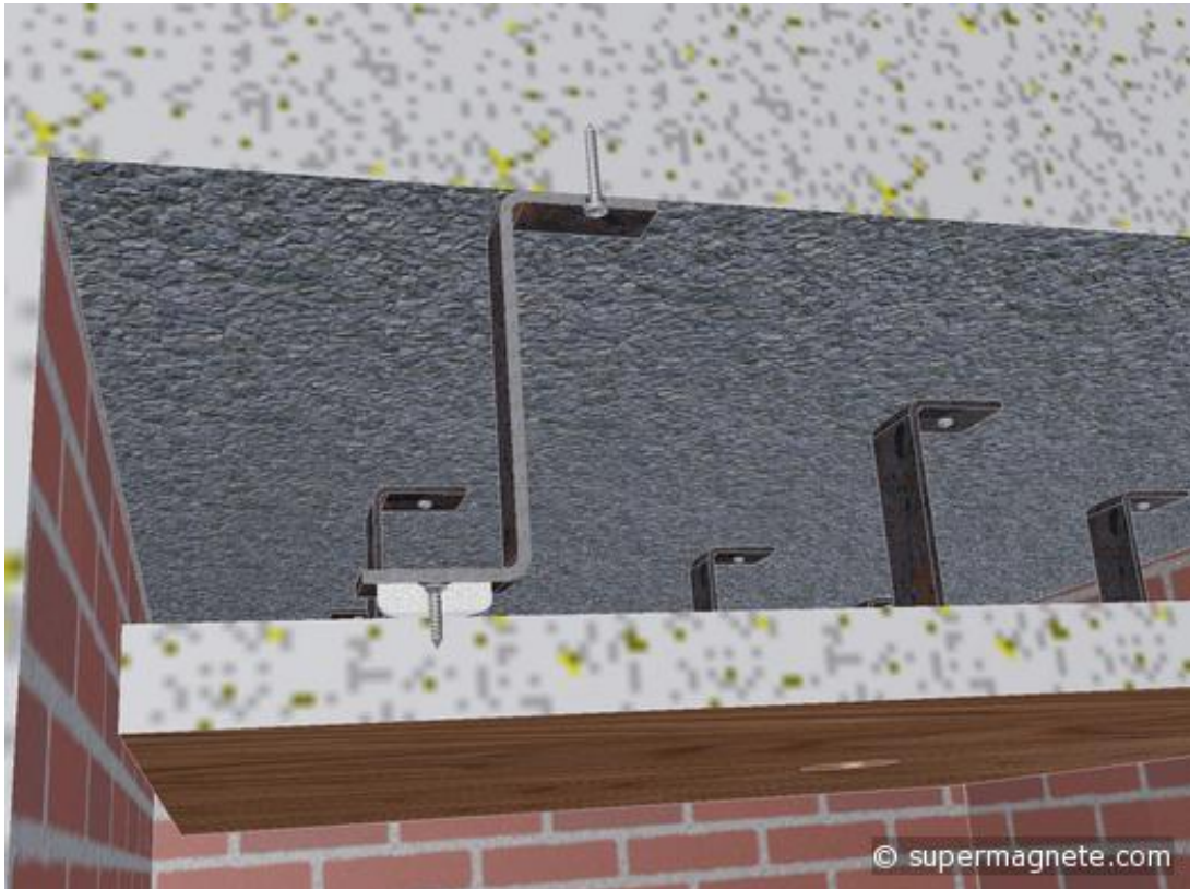
De computertekening laat zien waar de schroeven bevestigd zijn.
