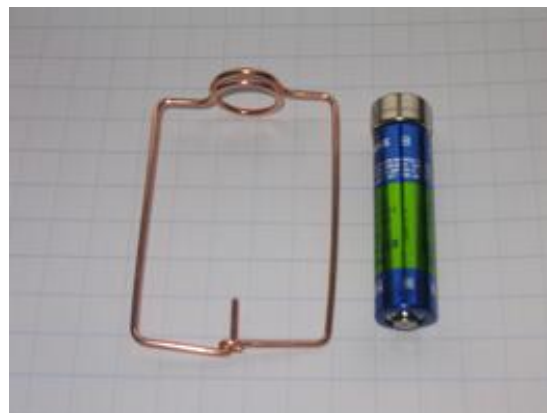
De volledige gebogen wikkeling en de batterij met de magneet
