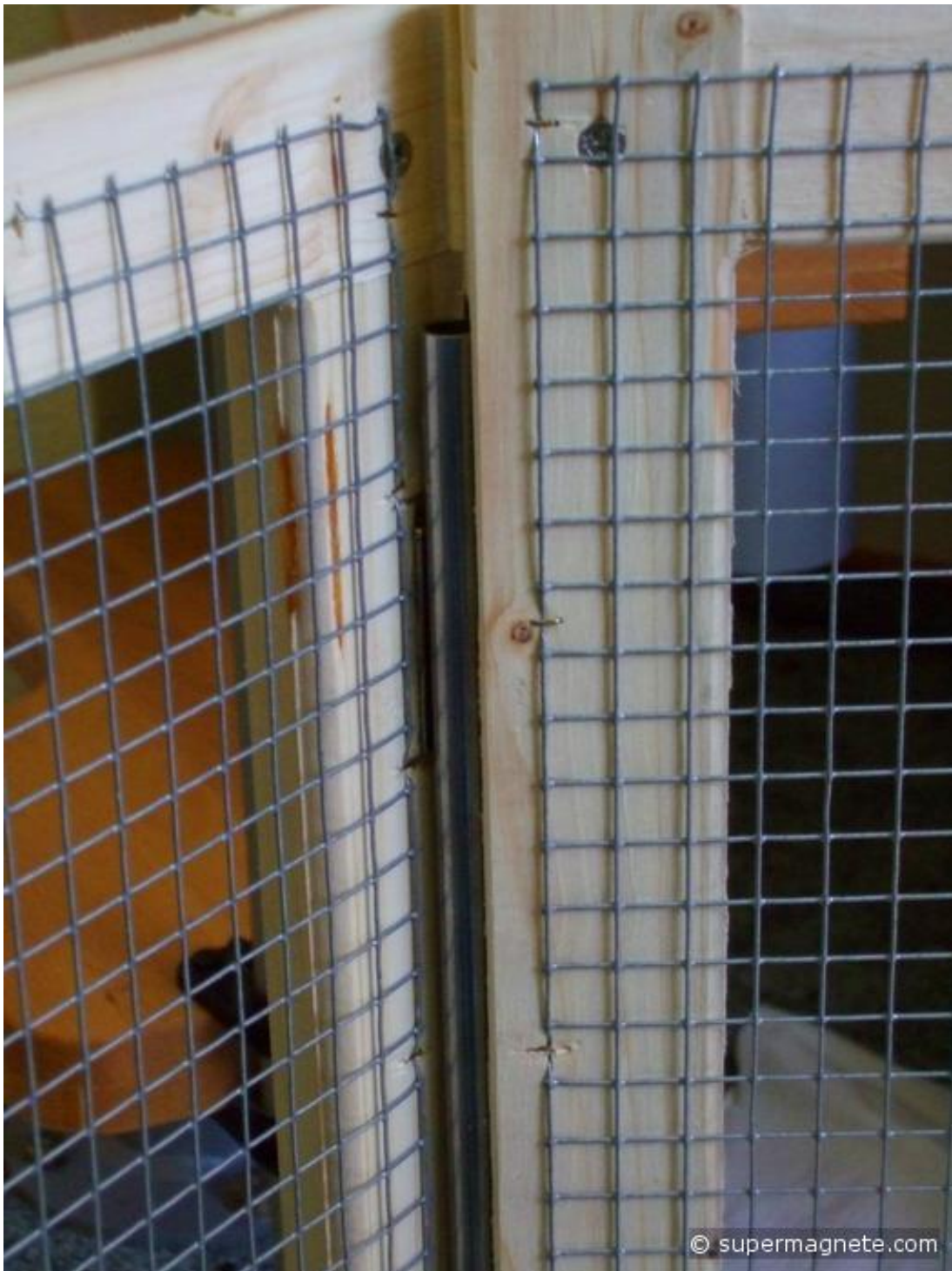
Les aimants adhèrent au tube, la construction reste pourtant flexible
