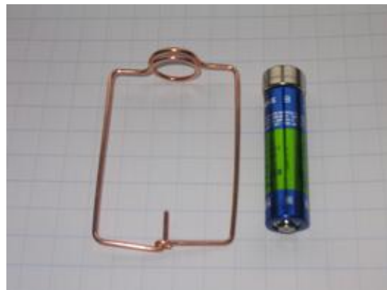
Circuit métallique terminé et batterie avec aimant
