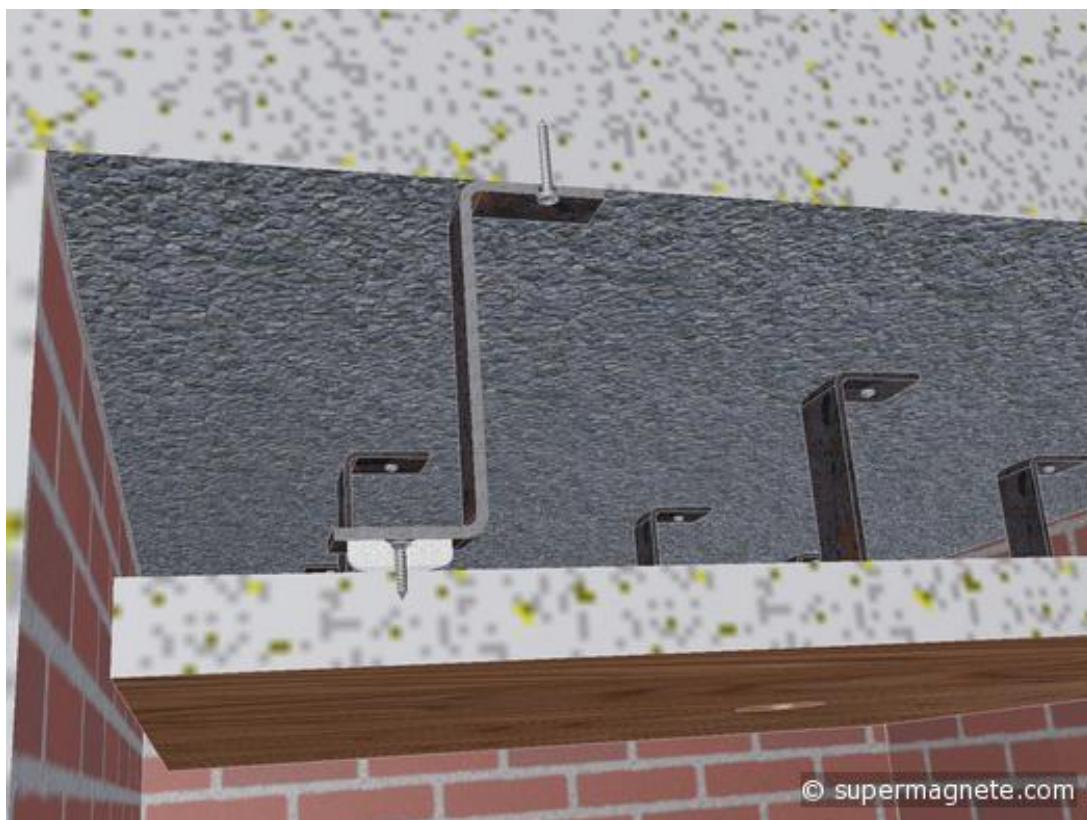
La grafica al computer mostra i punti in cui sono fissate le viti
