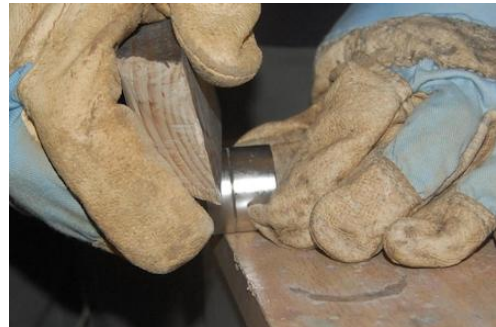
Hier sind die Magnete nicht ganz ideal platziert - die Tischkante sollte eigentlich genau unter den beiden Magneten sein!
