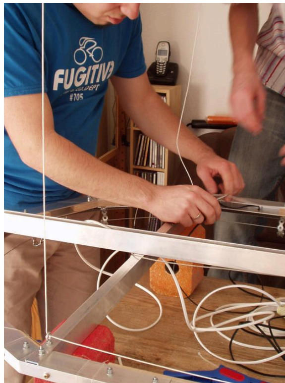
Hier das Gerüst aus Alu-Profilen
