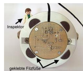
Untenansicht: Die Elektronik auf der Lochrasterplatine findet hier Platz. Kabel zur Versorgung der Kuppel werden durch die Bohrungen geführt.
