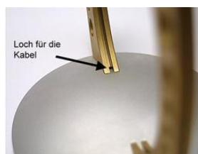
Untenansicht: Die Elektronik auf der Lochrasterplatine findet hier Platz. Kabel zur Versorgung der Kuppel werden durch die Bohrungen geführt.
