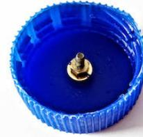
1. Die Plastikkappe auf ca. 10 mm Höhe zurückschneiden und, wenn nötig, die eingeklemmten Dichtungsteile im Innern in der Kappe entfernen. Auf letzteres könnte man verzichten – ich wollte aber sicherstellen, dass der Ringmagnet nicht durch die gummiartige Dichtung gebremst wird.
